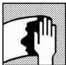
Préparer la surface avec de l'eau chaude et du détergent, puis rincer avec de l'eau propre. Essuyer toutes traces de poussières avec M700 (Anti Static Degreaser) ou M850.
