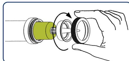
3 Placez l'adaptateur (8) sur la cartouche, insérez la cartouche dans le pistolet et serrez la bague.
